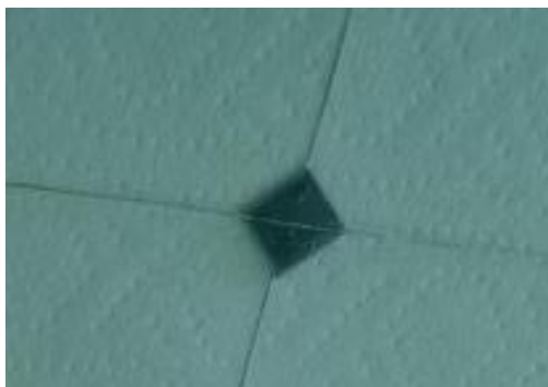
Рисунок 24 – Образец для измерений с нанесенными электродами и проводками
