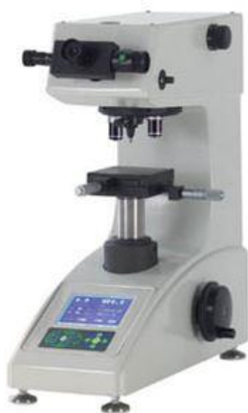
Рисунок 21 – Микротвердомер 402MVD Instron Wolpert Wilson Instruments
