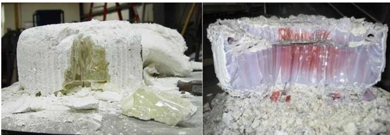
Рисунок 14 – Внешний вид столбчатых монокристаллов Фианита (слева) и стабилизированного циркония (справа), полученных гарниссажным плавлением
