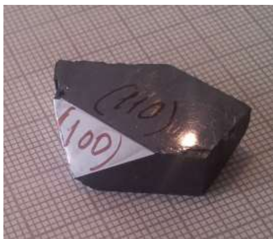
Рис. 3. Образец кристалла Cd_{0.96}Zn_{0.04}Te , выращенного в космосе. Показана ориентация плоскостей среза.
