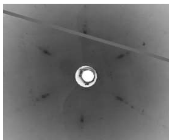
Рис. 8. Лауэграмма кристалла GaSe:1 ат% Er выращенного из расплава в горизонтальной печи.
