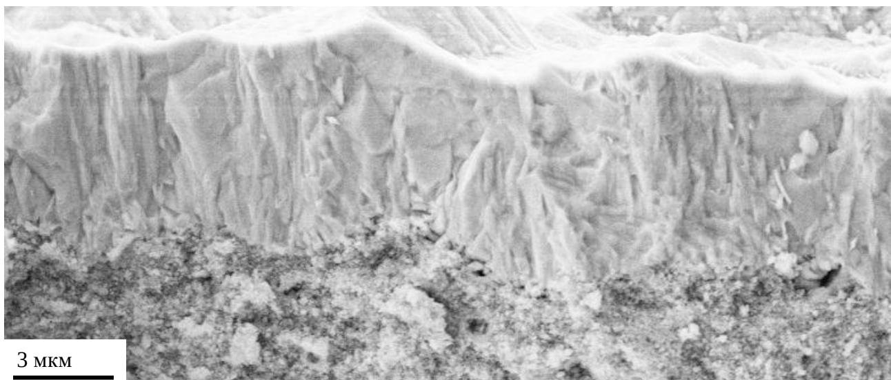
Рисунок 4 – СЭМ-изображение поперечного сечения образца с осажденным методом AD слоем Ni/GDC без предварительного обжига вакууме и напыленным магнетроном электролитом GDC.
