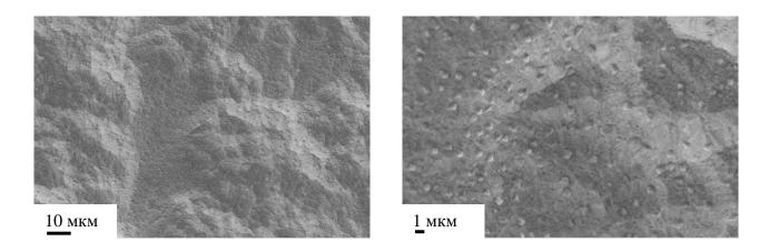
Рисунок 4.17 — СЭМ-изображение поверхности электролита GDC, осажденного магнетронным методом, после обжига в вакууме при 1000 °C.
