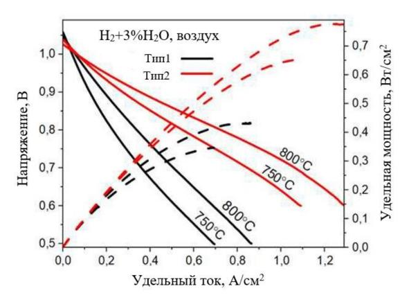
Рисунок 3.23 — BAX ТОТЭ с однослойным 8YSZ электролитом и LSM/10Sc1CeSZ катодом (Тип 1, черный) и двухслойным электролитом 8YSZ+GDC и LSC катодом (Тип 2, красный).
