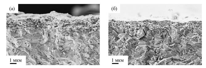
Рисунок 3.4 – СЭМ-изображения поперечного сечения электролита, осажденного с помощью метода AD из порошка №5 (а) и порошка №3 (б).
