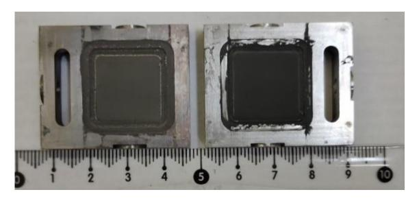
Рисунок 2.24 — Фотография монополярных пластин с вваренными пористыми металлическими подложками и с осажденным анодным слоем с термической обработкой в вакууме (слева) и без термической обработки в вакууме (справа).
