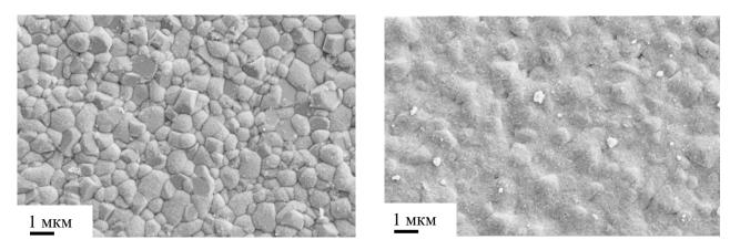
Рисунок 3.17 – Примеры эрозии поверхности анодной подложки после осаждения порошков №4 и №8 из щелевого сопла с установкой AD №2.
