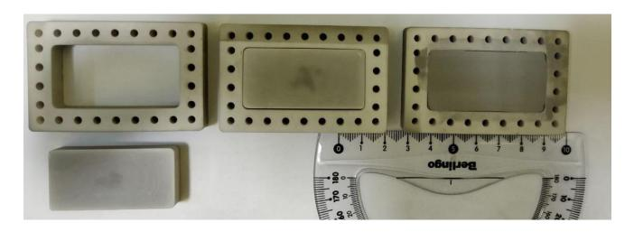
Рисунок 2.17 — Фотография керамических форм в разобранном (слева), собранном видах без (по центру) и с засыпанным (справа) металлическим порошком.
