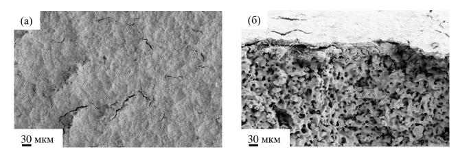
Рисунок 4.10 – СЭМ изображения поверхности (а) и сечения (б) Ni/GDC, осажденного при давлении в камере осаждения 6 Торр после спекания в условиях вакуума.
