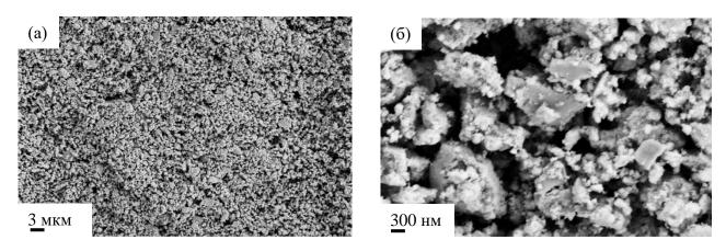
Рисунок 2.5 – СЭМ-изображения порошка 8YSZ №7 (а), №7 в большем увеличении (б).
