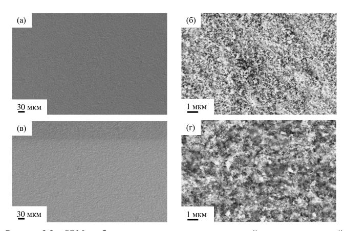
Рисунок 3.3 – СЭМ-изображения поверхности электролитной пленки, осажденной методом AD из порошка №5 (а-б) и №3 (в-г) под углом 45°.
