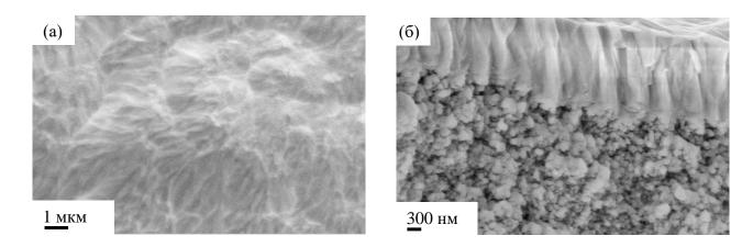
Рисунок 4.14 – СЭМ-изображение поверхности (а) и поперечного сечения (б) образца с осажденным методом AD анодным слоем Ni/GDC и напыленным магнетроном электролитом GDC.
