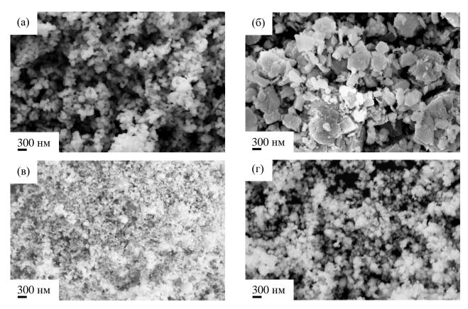
Рисунок 2.7 – СЭМ-изображения порошков 10Sc1YSZ (a), NiO (б), Ni (в), GDC (г).
