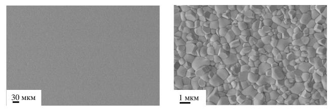
Рисунок 2.8 – СЭМ-изображения поверхности подложки анода (функциональный слой), использованной для осаждения электролита методом AD.
