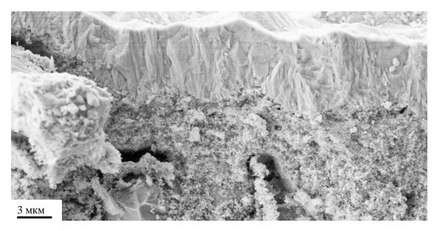
Рисунок 4.15 – СЭМ-изображение поперечного сечения образца с осажденным методом AD слоем Ni/GDC без предварительного обжига вакууме и напыленным магнетроном электролитом GDC.
