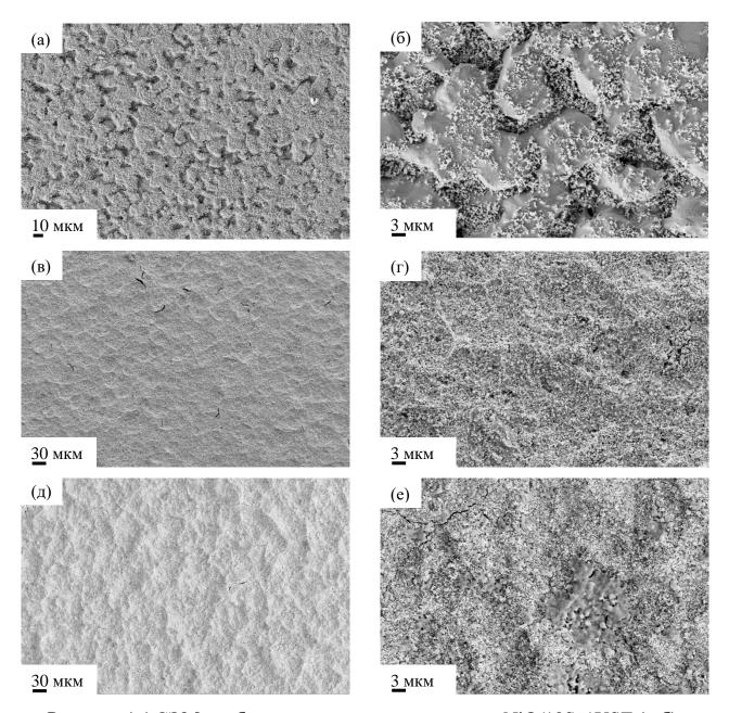
Рисунок 4.4 СЭМ-изображения поверхности анодов NiO/10Sc1YSZ (a-б), Ni/10Sc1YSZ (в-г), Ni/GDC (д-е) после обжига при температуре 1100 °C.
