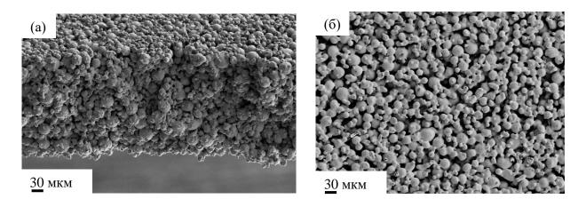
Рисунок 2.19 – СЭМ-изображение сечения (а) и поверхности (б) металлической подложки размером 25×50 мм.
