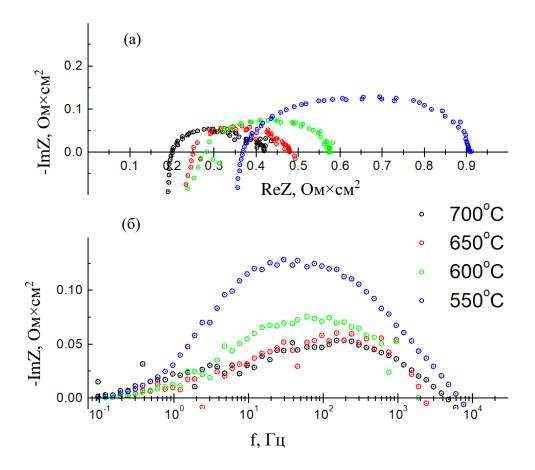
Рисунок 4.26 – Годографы (a) и частотная зависимость мнимой части импеданса (б) сборки металл-поддерживаемых ТОТЭ.
