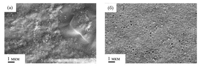
Рисунок 3.9 – СЭМ-изображения электролита GDC, осажденного методом AD на 8YSZ слой до (а) и после спекания при 1200 °C (б).
