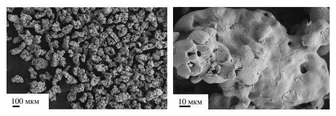
Рисунок 2.13 – СЭМ-изображения порошка X17H2 до просеивания при различных увеличениях.
