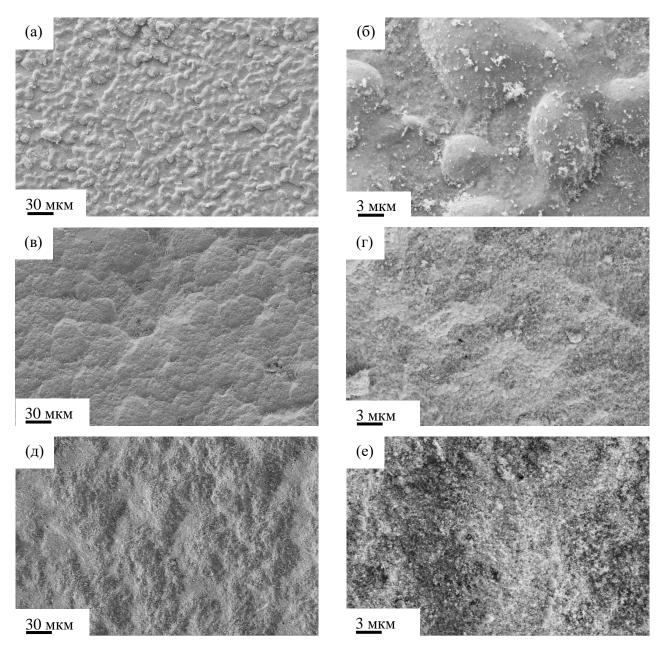
Рисунок 4.1 – СЭМ-изображения поверхности анода, осажденного из композитов NiO/10Sc1YSZ (63/37 масс.%) (а-б), Ni/10Sc1YSZ (50/50 масс.%) (в-г), Ni/GDC (50/50 масс.%) (д-е).
