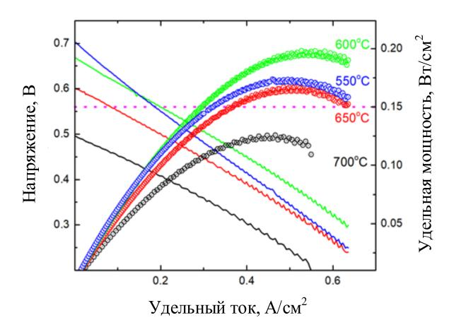
Рисунок 4.25 – BAX и мощностные характеристики сборки металлподдерживаыемых ТОТЭ.
