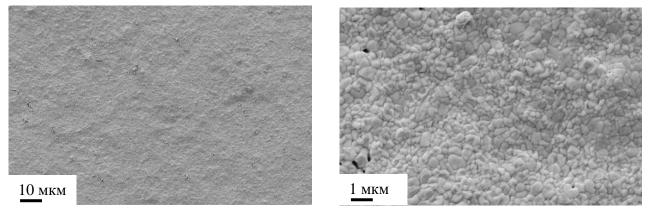
Рисунок 3.15 — СЭМ-изображения поверхности GDC электролита, спеченного при температуре  $1200~^{\circ}$ С, осажденного на спеченный при  $1300~^{\circ}$ С слой 8YSZ образца размером  $50\times50~\mathrm{mm}$ .
