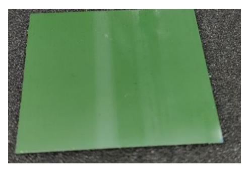
Рисунок 3.13 — Фотография анодной подложки размером 50×50 мм после осаждения электролита 8YSZ методом AD.
