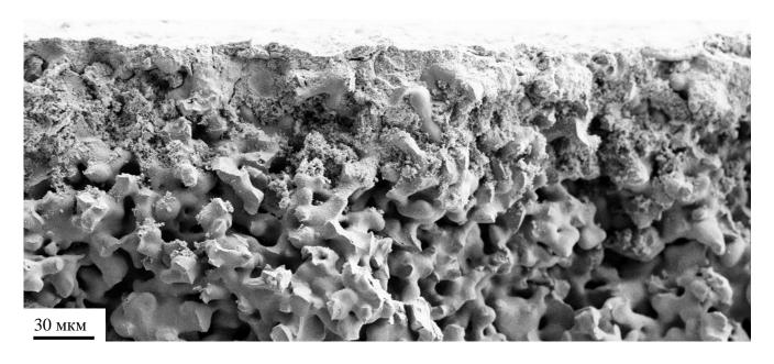
Рисунок 4.12 — СЭМ-изображение поперечного сечения металлической пористой подложки с функциональным анодом Ni/GDC, осажденным методом AD и обожжённым в вакууме при температуре 1000 °C.
