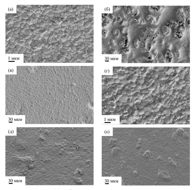
Рисунок 3.1 – СЭМ-изображения поверхности анодной подложки после осаждения порошков №1 – №6 методом AD из сопла 0,5 мм и установкой №1.
