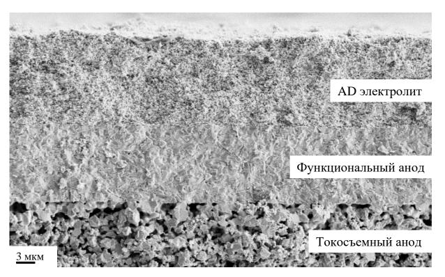
Рисунок 3.6 – СЭМ-изображение сечения электролита, осажденного на анодную подложку с помощью метода AD из порошка №5.
