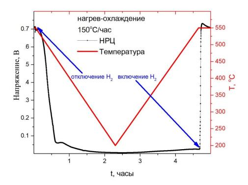
Рисунок 4.27 – График зависимости напряжения разомкнутой цепи (черная) и температуры горячей зоны (красная) от времени во время цикла охлаждениенагрев №3.
