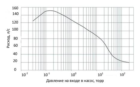
Рисунок 2.10 – Характеристика насоса установки №1.
