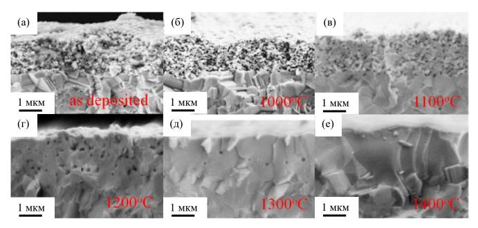
Рисунок 3.7 – СЭМ-изображения сечения электролита частей одного образца после осаждения порошка №5 методом AD (а) и спеченного при температурах  $1000~^{\circ}$ C (б),  $1100~^{\circ}$ C (в),  $1200~^{\circ}$ C (г),  $1300~^{\circ}$ C (д),  $1400~^{\circ}$ C (е).
