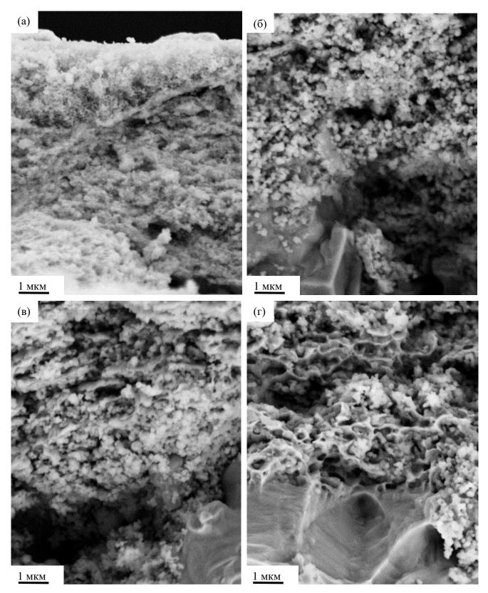
Рисунок 4.6 — Сечения Ni/10Sc1YSZ после осаждения (a) и после вакуумного обжига при температурах 900 °C (б), 1000 °C (в), 1100 °C (г).
