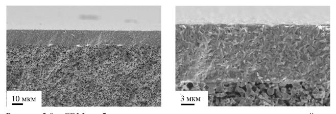
Рисунок 2.9 – СЭМ-изображения сечения подложки анода, использованной для осаждения электролита методом AD.
