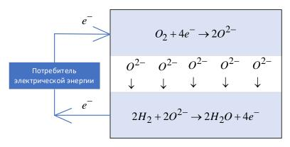
Рисунок 1.2 – Принцип работы ТОТЭ.
