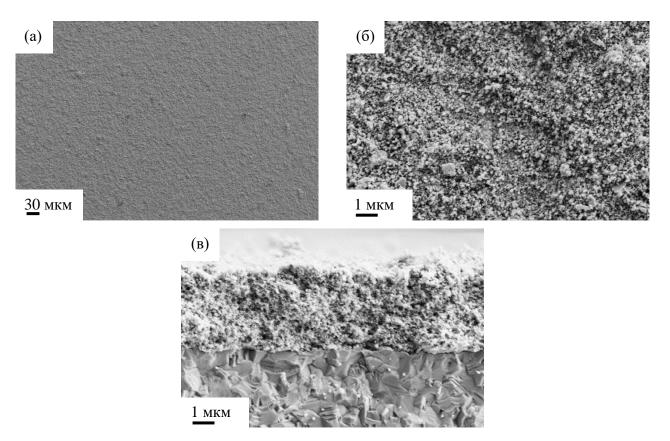
Рисунок 3.11 СЭМ-изображения поверхности (a - 6) и сечения (в) 8YSZ электролита, осажденного методом AD на подложку  $50 \times 50$  мм.
