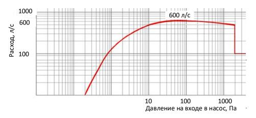
Рисунок 2.11 – Характеристика насоса установки №2.
