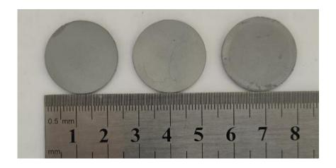
Рисунок 2.16 — Серия подложек из металла марки X17H2, сформированных методом одноосного прессования и отоженных в вакууме.
