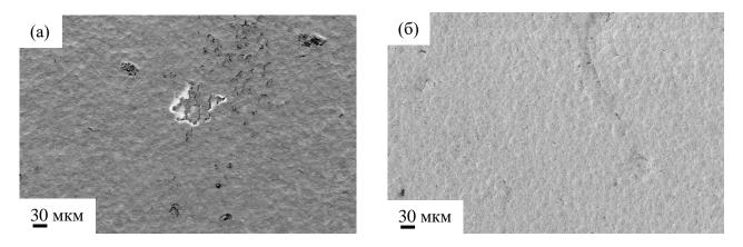
Рисунок 3.2 – Поверхность электролитных пленок, осажденных методом AD из порошков №5 (а) и №3 (б) после спекания при температуре 1350 °C.
