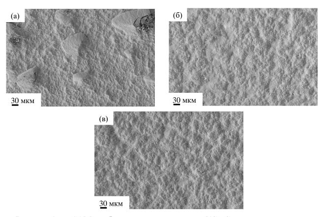
Рисунок 4.9 – СЭМ изображения поверхности Ni/GDC слоя, осажденного при давлениях в камере осаждения 0,5 Торр (а), 1,5 Торр (б), 6 Торр (в).
