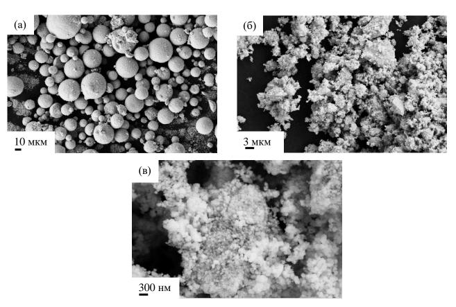
Рисунок 2.3 – СЭМ-изображения порошков 8YSZ №2 (а), №5 (б), №5 в большем увеличении (в).
