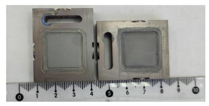
Рисунок 2.25 — Фотография монополярных пластин с нанесенным анодным и электролитным слоями.
