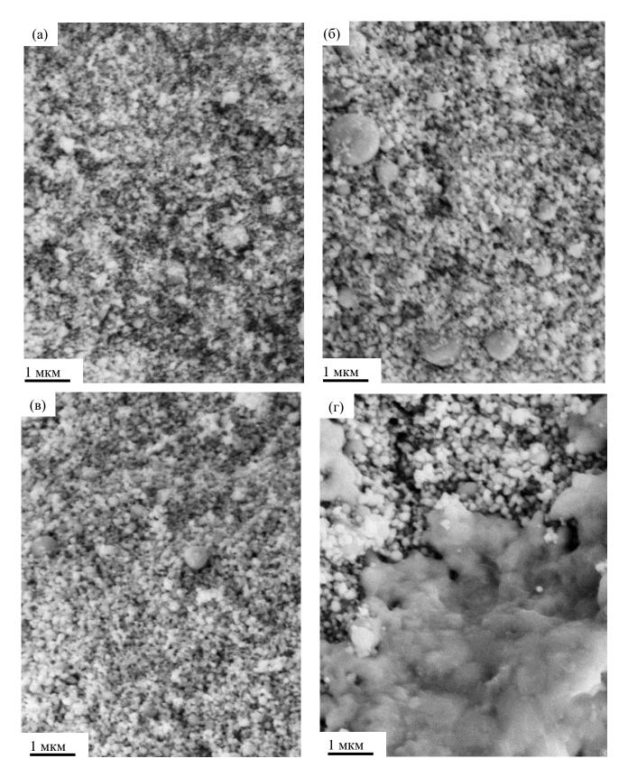
Рисунок 4.7 – СЭМ-изображения поверхности слоя Ni/GDC после осаждения (a) и после вакуумного обжига при температурах 900 °C (б), 1000 °C (в) и 1100 °C (г).
