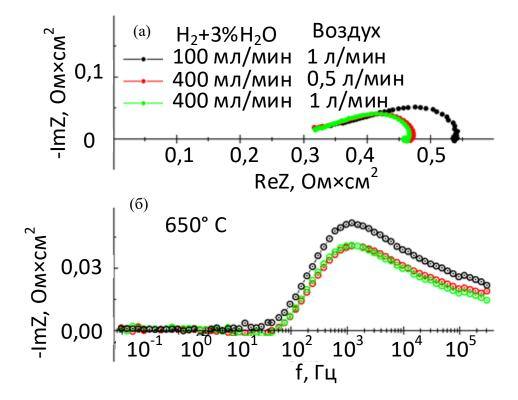
Рисунок 4.24 – Годографы (a) и частотные зависимости мнимой части (б) импедансных спектров металл-поддерживаемого ТОТЭ, измеренные при различных потоках реагентов.
