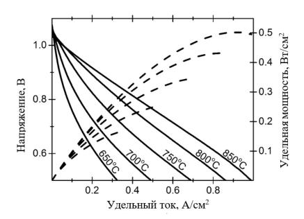
Рисунок 3.20 – BAX ТОТЭ с 8YSZ электролитом и LSM/10Sc1CeSZ катодом.
