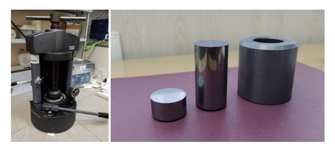
Рисунок 2.14 — Лабораторный гидравлический пресс (слева) и цилидрическая пресс-форма (справа).
