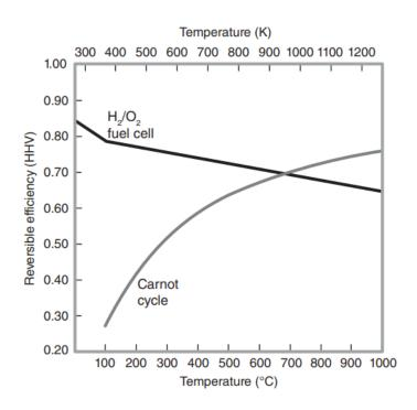
Рисунок 1.1 – Зависимость КПД идеального топливного элемента и цикла Карно от максимальной температуры работы [16].
