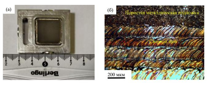
Рисунок 2.23 — Фотография монополярной пластины с вваренной пористой металлической подложкой (а) и изображение сварного шва, полученное с помощью оптического микроскопа (б).
