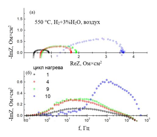
Рисунок 4.29 – Годографы (а) и частотная зависимость мнимой части импеданса (б) сборки металл-поддерживаемых ТОТЭ, измеренные после последовательных циклов охлаждение-нагрев.
