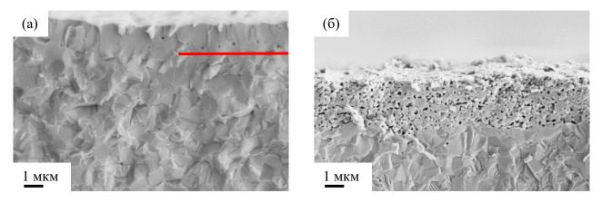
Рисунок 3.5 – СЭМ-изображения электролита, осажденного с помощью метода AD из порошка №5 и спеченного при 1300 °C (а), из порошка №3 и спеченного при 1350 °C (б).
