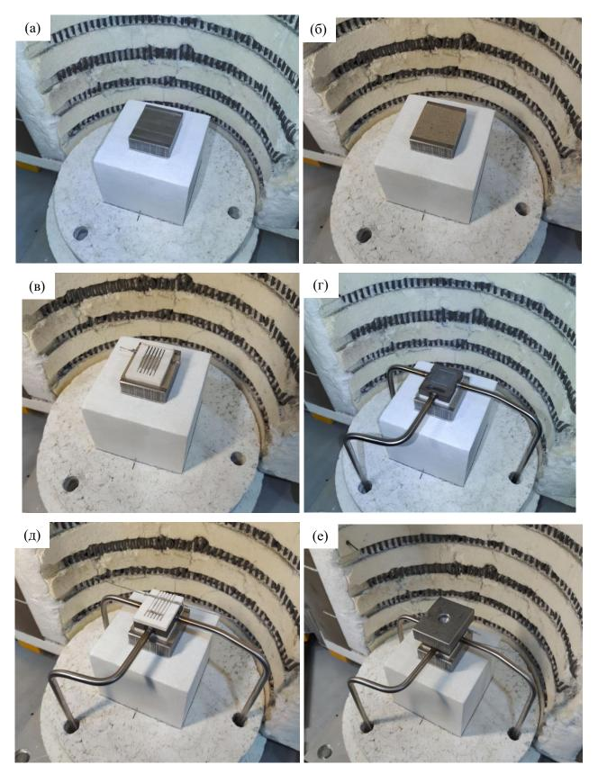
Рисунок 2.26 – Процесс монтажа сборки металл-поддерживаемых ТОТЭ.
