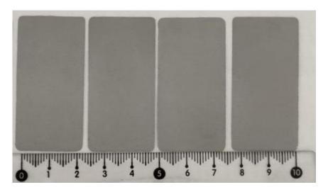
Рисунок 2.20 — Фотография серии металлических подложек размером 25×50 мм, изготовленных методом формования в керамической форме.
