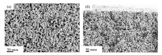
Рисунок 2.15 СЭМ-изображения поверхности (a) и сечения (б) металлической пористой подложки диаметром 23 мм.
