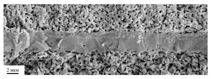
Рисунок 3.22 – СЭМ изображение сечения ТОТЭ диаметром 21 мм с двухслойным 8YSZ+GDC электролитом, изготовленным методом AD, и LSC катодом.
