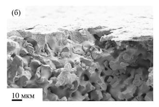
Рисунок 4.2 – СЭМ-изображения сечения металлической подожки с анодом, осажденным из порошка Ni/10Sc1YSZ (50/50 масс.%) (а) и Ni/GDC (50/50 масс.%) (б).
