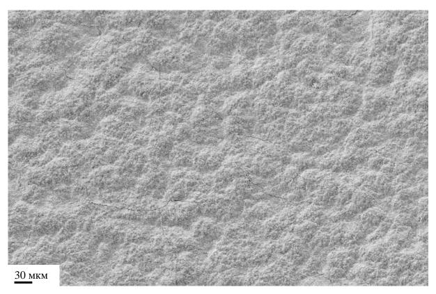
Рисунок 4.11 – СЭМ-изображение поверхности функционального анода Ni/GDC, осажденного методом AD и обожжённого в вакууме при температуре 1000 °C.
