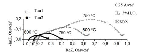
Рисунок 3.24 — Годограф импеданса ТОТЭ с однослойным 8YSZ электролитом и LSM/10Sc1CeSZ катодом (Тип 1) и двухслойным электролитом 8YSZ+GDC и LSC катодом (Тип 2).
