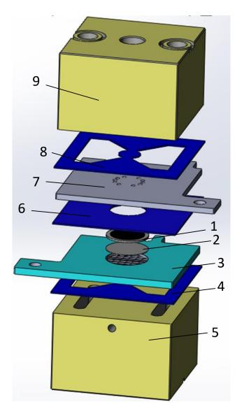
Рисунок 2.28 – 3-D модель измерительной ячейки. 1 – МЭБ ТОТЭ, 2 – никелевая сетка, 3 – анодная пластина, 4 – анодная герметизирующая прокладка, 5 – анодный газораспредетлительный блок, 6 – центральная герметизирующая прокладка, 7 – катодная пластина, 8 – катодная герметизирующая прокладка, 9 – катодный газораспределительный блок.
