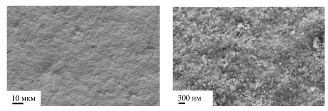
Рисунок 3.14 — СЭМ-изображения поверхности GDC электролита, осажденного на спеченный при 1300 °C слой 8YSZ образца размером 50×50 мм.
