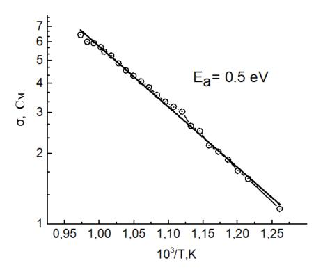
Рисунок 4.23 – Температурная зависимость обратных омических потерь исследуемого образца ТОТЭ.
