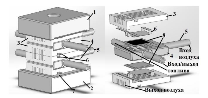
Рисунок 2.21 — 3-D модель сборки ТОТЭ металл-поддерживаемой конструкции (1 — давящая пластина, 2 — опорная пластина, 3 — керамические разделители, 4 — монополярная пластина, 5 — трубы, 6 — катодная сетка, 7 — изолирующая прокладка, 8 — МЭБ ТОТЭ.).
