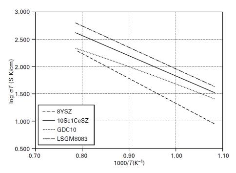
Рисунок 2.1 – Зависимость ионной проводимости некоторых электролитов ТОТЭ от температуры [54].
