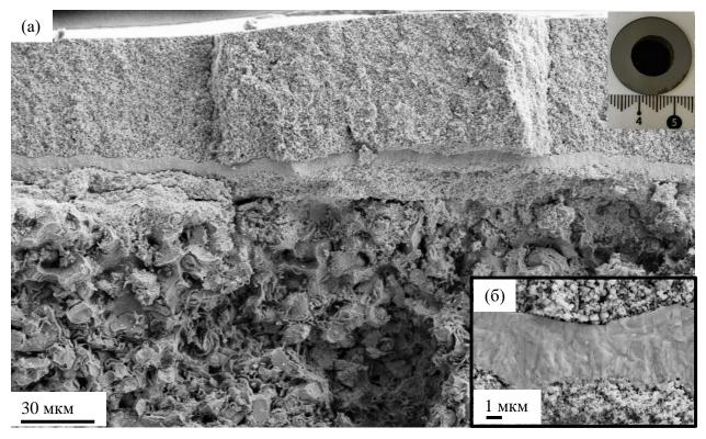
Рисунок 4.18 — Фото до испытаний и СЭМ-изображение поперечного сечения металл-поддерживаемого ТОТЭ после испытаний в меньшем увеличении (а) и при увеличении электролита (б).
