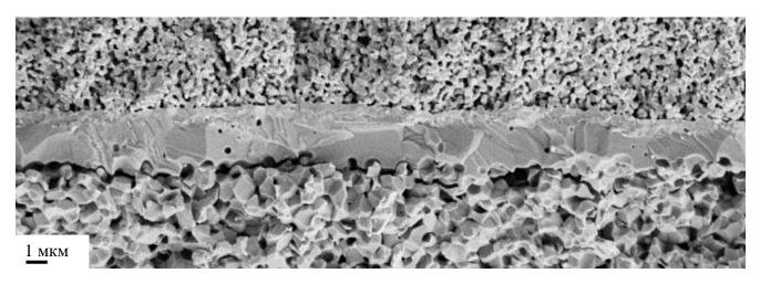
Рисунок 3.25 – СЭМ-изображение сечения образца анод-поддерживаемого ТОТЭ размером 50×50 мм с 8YSZ и GDC электролитами.
