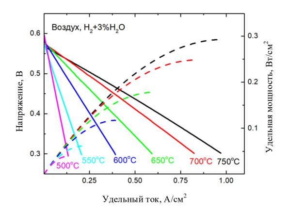
Рисунок 4.19 — ВАХ и мощностные зависимости металл-поддерживаемого ТОТЭ, измеренные при температурах 500-750 °C.
