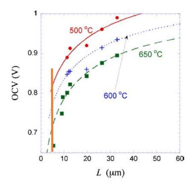
Рисунок 4.21 — Зависимость НРЦ от толщины GDC-электролита. Оранжевым отрезком отмечена толщина электролита около 5 мкм [77].
