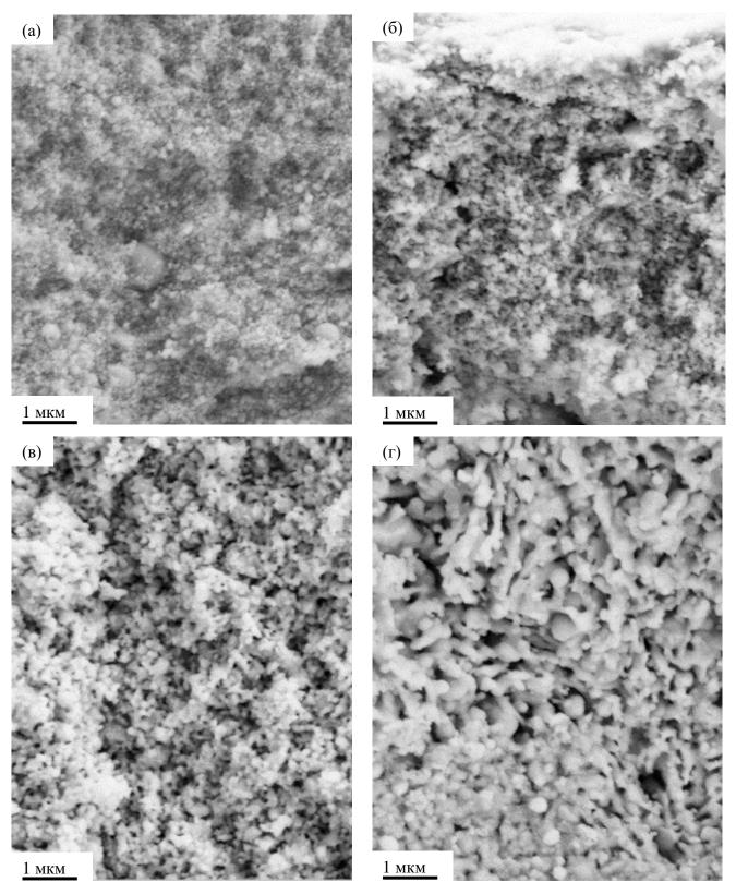
Рисунок 4.8 — СЭМ-изображения поперечного сечения слоя Ni/GDC после осаждения (а) и после вакуумного обжига при температурах 900 °C (б),  $1000~^{\circ}\text{C (B)},\,1100~^{\circ}\text{C (r)}.$
