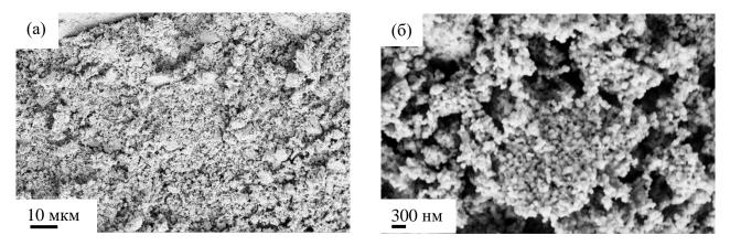
Рисунок 2.6 – СЭМ-изображения порошка GDC.
