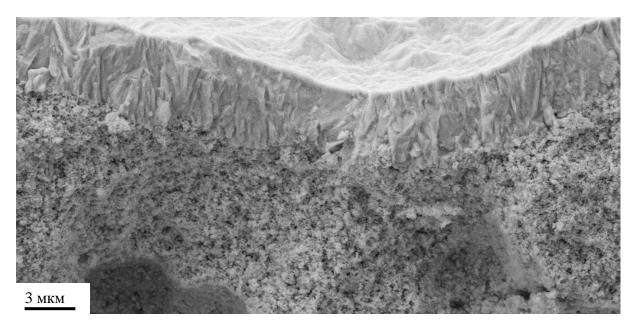
Рисунок 4.16 – СЭМ-изображение поперечного сечения образца с осажденным методом AD слоем Ni/GDC с предварительным обжигом в вакууме при 1000 °C и напыленным магнетроном электролитом GDC.
