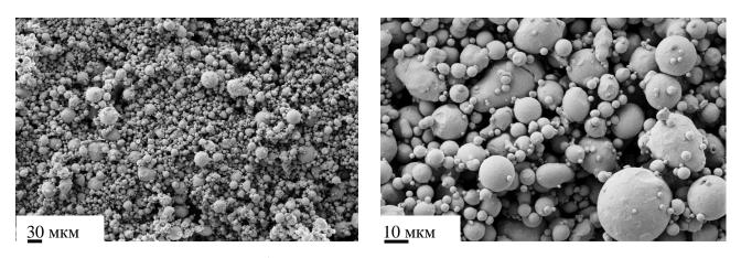
Рисунок 2.18 – СЭМ-изображения порошка AISI 430L до просеивания при различных увеличениях.
