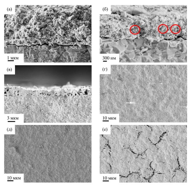
Рисунок 3.16 – СЭМ-изображения электролита, осажденного из порошка 8YSZ №7, (а) сечение после осаждения, (б) сечение после спекания при температуре 900 °C, (в) сечение после спекания при температуре 1300 °C, (г) поверхность после осаждения, (д) поверхность после спекания при температуре 900 °C, (е) поверхность после спекания при температуре 1300 °C.
