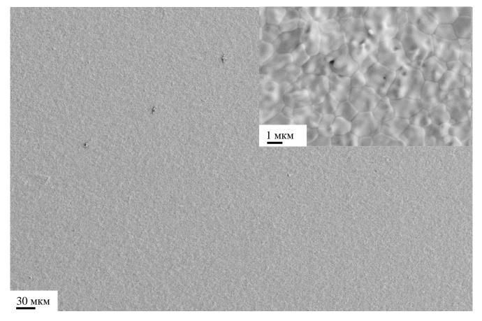
Рисунок 3.8 – Изображения поверхности 8YSZ электролита, осажденного методом AD, после спекания при 1300 °C.
