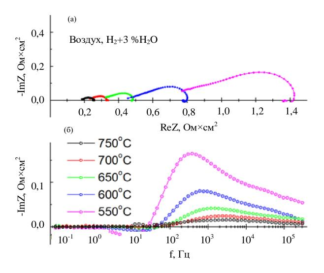
Рисунок 4.22 – Годографы (а) и частотные зависимости мнимой части (б) импедансных спектров металл-поддерживаемого ТОТЭ, измеренные при температурах 550–750 °C.
