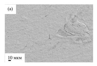
Рисунок 3.10 – СЭМ-изображение поверхности 8YSZ электролита, осажденного методом AD с использованием установки №1 на подложку 50×50 мм и спеченного при 1300 °C.
