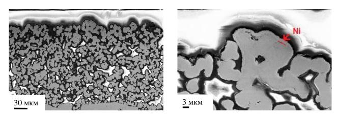
Рисунок 2.22 – СЭМ-изображения шлифов сечения металлических подложек после покрытия слоем Ni.
