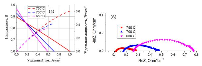
Рисунок 3.26 – BAX (а) и годограф импеданса (б) образца ТОТЭ размером 50×50 мм с 8YSZ+GDC электролитом, изготовленным методом AD, и LSCF+GDC/LSCF катодом.
