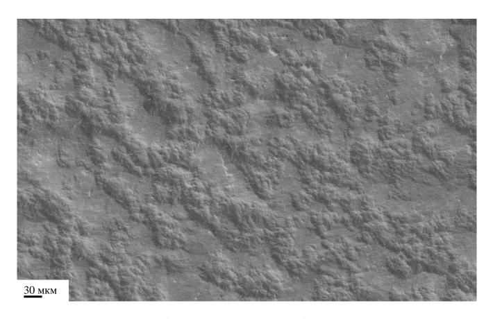
Рисунок 4.13 – СЭМ-изображения поверхности образца с осажденным методом магнетронного напыления GDC электролитом на Ni/GDC анод.
