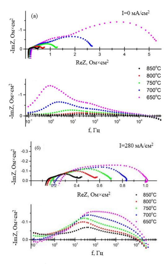
Рисунок 3.21 – Годографы импеданса и зависимости мнимой части импедансного спектра от частоты для ТОТЭ с 8YSZ электролитом и LSM/10Sc1CeSZ катодом под нулевым током нагрузки (а) и под током нагрузки 280 мА/см² (б).
