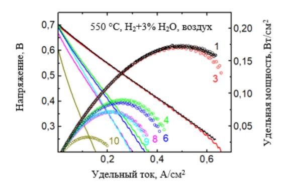
Рисунок 4.28 – ВАХ и мощностные характеристики сборки металлподдерживаыемх ТОТЭ, измеренные после последовательных циклов охлаждение-нагрев. Цифры на графике отвечает номеру цикла.
