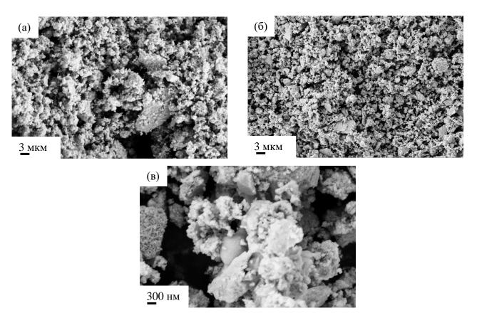
Рисунок 2.4 – СЭМ-изображения порошков 8YSZ №3 (а), №6 (б), №6 в большем увеличении (в).
