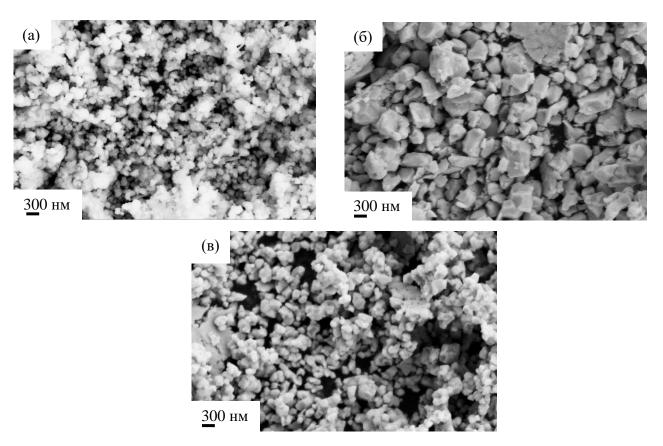
Рисунок 2.2 — СЭМ-изображения порошков 8YSZ №1 (а), №4 (б), №8 (в).
