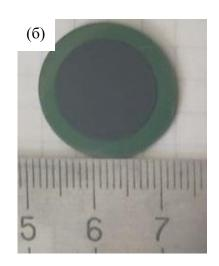
Рисунок 3.18 — Фотография полуэлемента с 8YSZ электролитом, осажденным методом AD (a), фотография ТОТЭ с 8YSZ электролитом, осажденным методом AD, и спеченным при температуре 1300 °C и LSM/10Sc1CeSZ катодом, нанесенным методом трафаретной печати (б).
