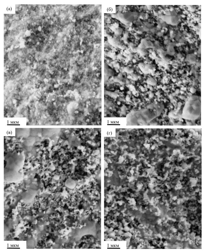
Рисунок 4.5 – Поверхность Ni/10Sc1YSZ после осаждения (a) и после вакуумного обжига при температурах 900 °C (б), 1000 °C (в), 1100 °C (г).
