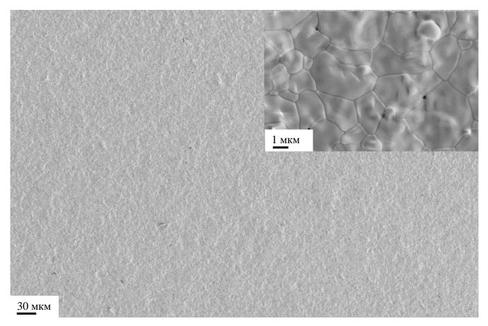
Рисунок 3.12 – СЭМ-изображение поверхности электролита 8YSZ, осажденного на никель/керамический анод размером 50×50 мм с использованием установки AD № 2, после обжига при температуре 1300 °C.
