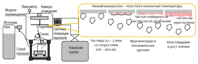
Рисунок 1.3 – Схема установки метода AD и принципа формирования пленок.
