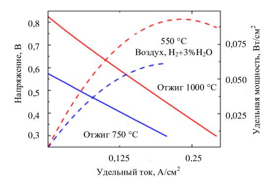
Рисунок 4.20 – ВАХ и мощностные зависимости металл-поддерживаемого ТОТЭ с предварительным нагревом в измерительной ячейке до температуры 750 °C (синие кривые) и 1000 °C (красные кривые), измеренные при температуре 550 °C.
