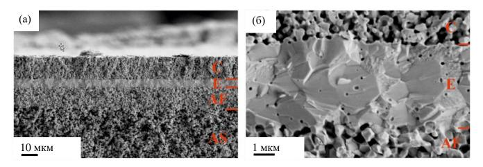
Рисунок 3.19 — СЭМ-изображения сечения образца ТОТЭ с 8YSZ мембранной, осажденной методом AD и спеченной при температуре 1300 °C (а), увеличенное изображение сечения электролитной мембраны (б).
