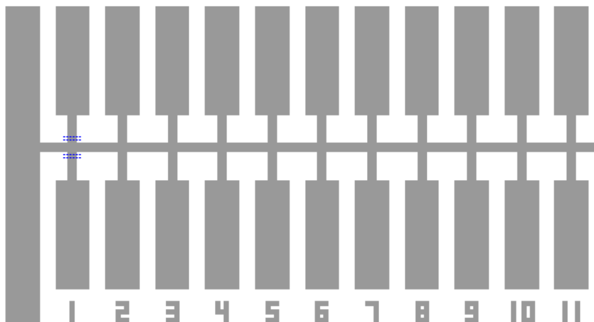
Рис. 35. Часть чертежа структуры, использовавшейся для изучения профиля осаждения мишеней. Синими пунктирными линиями показаны траектории измерения профилометром.
