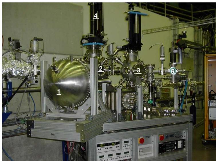
Рисунок 3.14. Электронный спектрометр «Mustang» Российско-Германской лаборатории BESSY 1 - анализатор, 2 - аналитическая камера, 3 - камера подготовки образцов, 4 – прецизионный манипулятор, 5 – камера перегрузки образцов.
