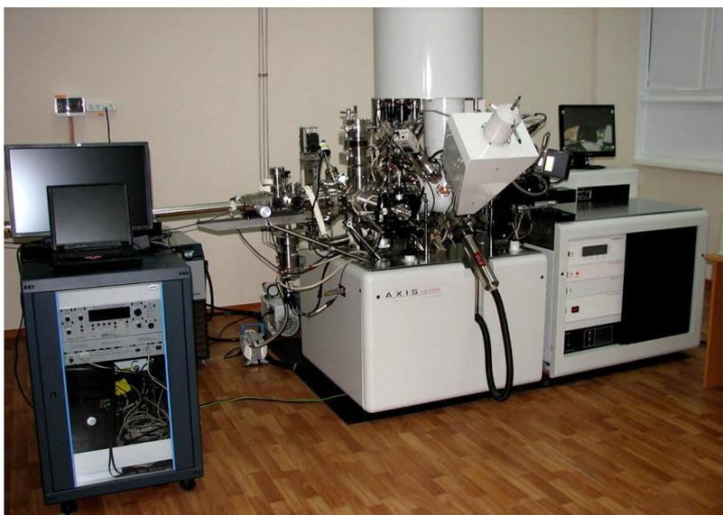
Рис.3.13. Фотоэлектронный спектрометр «Kratos AXIS Ultra DLD».
