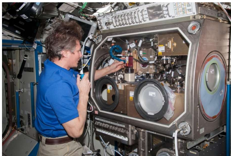
Рис. 2. Геннадий Падалка юстирует видеокамеру, используемую для регистрации изображений смектических пузырей в эксперименте OASIS.
