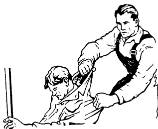
Рис.2.4. Освобождение пострадавшего от тока для ЭУ напряжением до 1000 В оттаскиванием за сухую одежду
