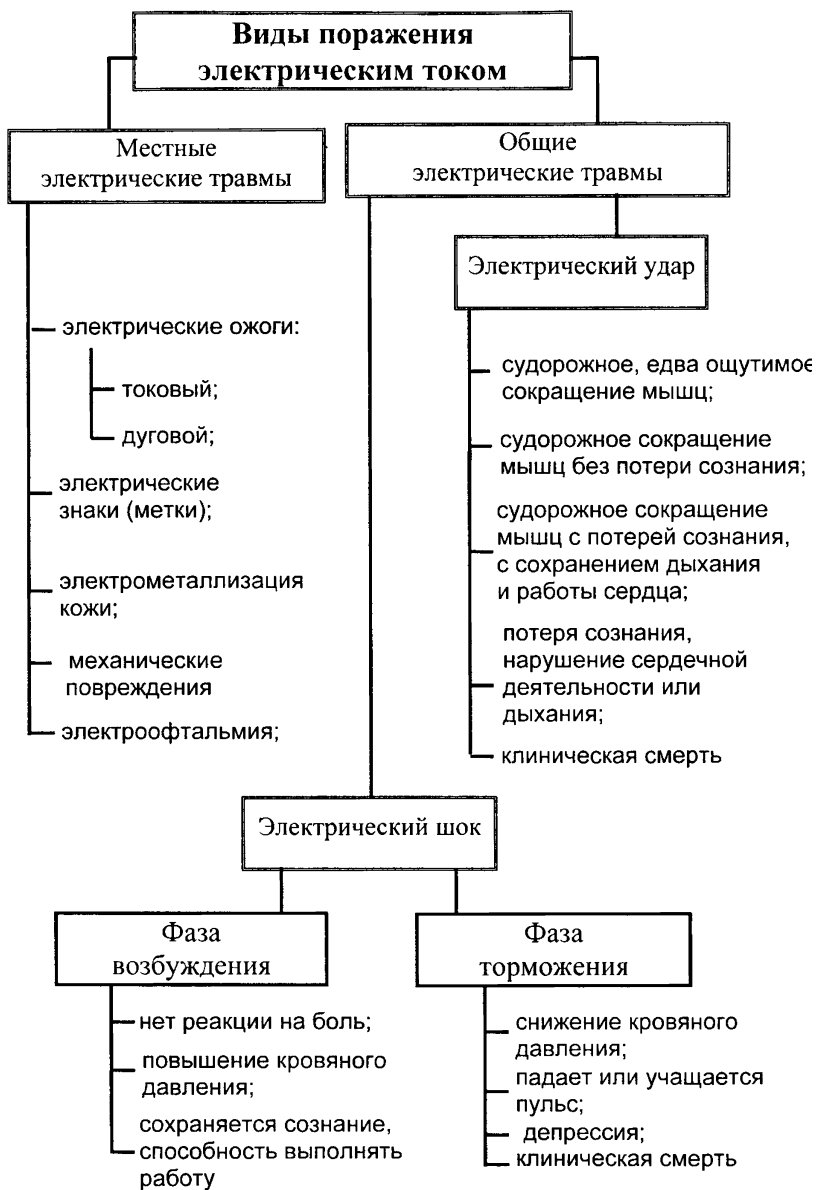
Рис.1.1. Классификация видов поражения электрическим током
