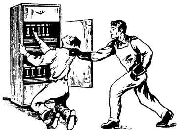
Рис.2.5. Отделение пострадавшего от токоведущей части, находящейся под напряжением до 1000 В
